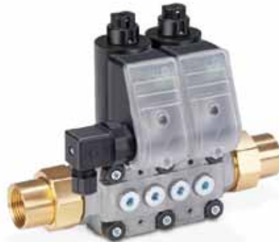
Bild 6: Zentrale Absperrereinrichtung. Diese muss nach DIN EN 161 min. der Klasse C entsprechen und aus zwei hintereinander geschalteten Ventilen bestehen. Bild: Elster GmbH
