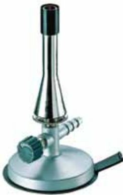
Bild 3: Laborbrenner nach DIN 30665-1. Das Abstellen der Gaszufuhr mittels Nadelventil darf nicht möglich sein. Hintergrund ist, dass sich im Schlauch befindliches Restgas verflüchtigen kann. Bild: Carl Friedrich Usbeck KG
